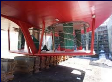
Voith Schneider Propeller
